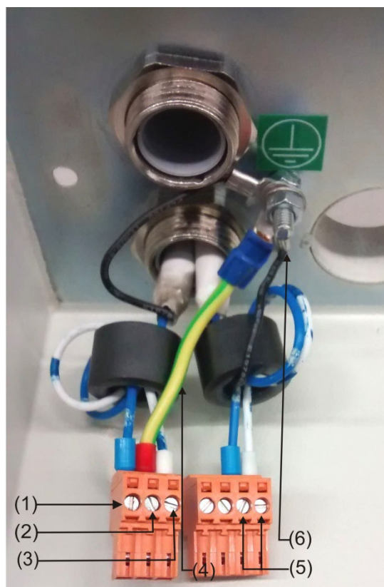
Bild 11: Ström- och signalanslutningar till dockningsstationen
