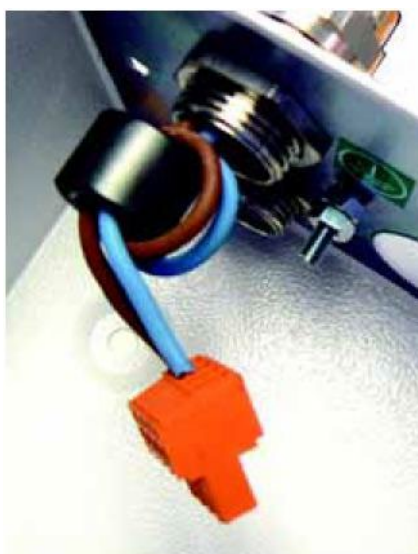
Afbeelding 8: Lus relaisverbindingskabels rond een ondrukkingsferriet
