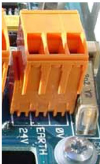
Figura 9: Morsetti dell'alimentatore del rivelatore
