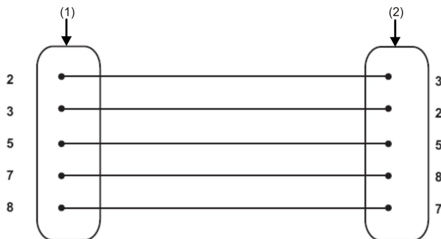
Figura 17: Conexiones del cable RS-232
