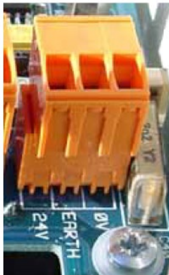
Figura 9: Terminales de la fuente de alimentación del detector
