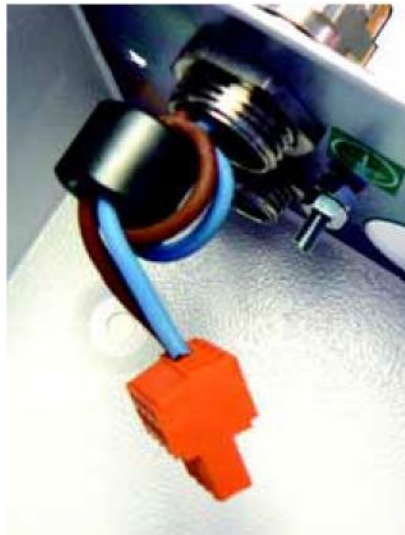
Rysunek 8: Tworzenie pętli przewodów połączeniowych przekaźnika wokół ferrytu
