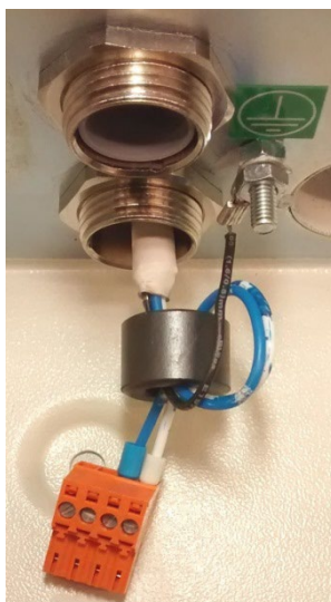
Abbildung 8: Relais-Anschlussdrähte – um einen Ferritring gewickelt
