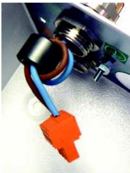
Figura 8: Cavi di collegamento del relè avvolti attorno a una ferrite per la soppressione
